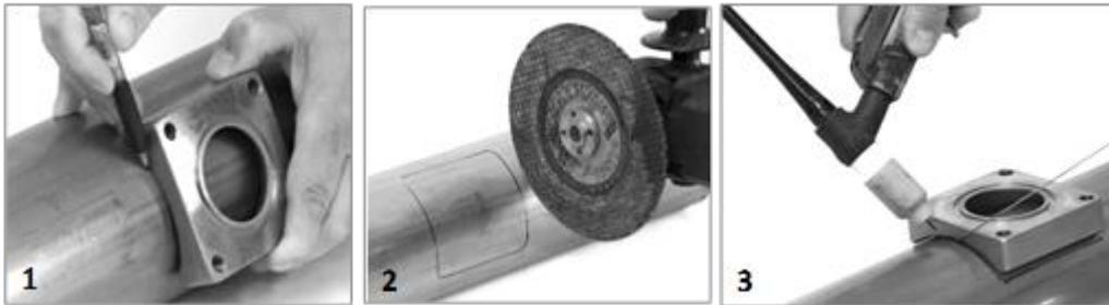
1. Markieren Sie die benötigte Flanschöffnung am gesamten Rohr.
