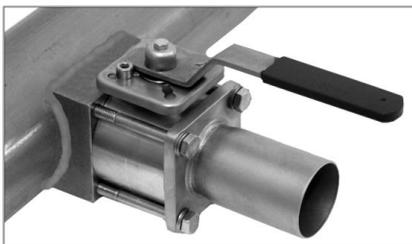
Bei der Druckprüfung ist der Nenndruck (PN) des Kugelhahns zu berücksichtigen. Wenn der Kugelhahn geschlossen ist, wird als Prüfdruck höchstens 1,1 x PN empfohlen. Ein höherer Prüfdruck kann ein Verformen der weichen Kugeldichtungen verursachen. Wenn der Kugelhahn geöffnet ist, wird als Prüfdruck höchstens 1,5 x PN empfohlen.
